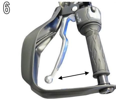
**WICHTIG: Überprüfen Sie regelmäßig die Ausrichtung der Handschützer und die Spannung der Befestigungsschrauben. / IMPORTANT: Always check alignment of hand guards and mounting bolt tension periodically.**
