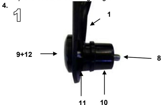
5. Montieren Sie nun die Halter in Fahrtrichtung links (2) in dem Sie zuerst den Spiegel demontieren, den Halter auf den Spiegeladapter auf legen und dann den Spiegel wieder aufschrauben und somit den Halter fixieren. Abb.2 / *Fit the bracket on the left in the direction of travel (2) by first dismantling the mirror, placing the bracket on the mirror adapter and then screwing the mirror back on and thus fixing the bracket. Fig. 2*
