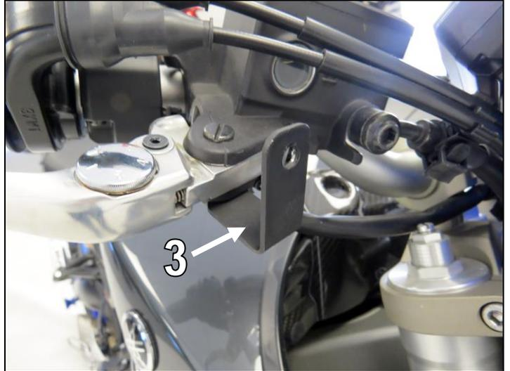
3. Demontieren Sie nun am Kupplungshebel die Befestigungsschraube, legen Sie zuerst eine Faser-U-Scheibe (14) und dann den Halter in Fahrtrichtung links (2) von oben auf den Adapter und führen Sie die Originalschraube wieder komplett bis nach unten durch (Faser-U-Scheibe muss zwischen Halter und Adapter liegen!). Sichern Sie die Schraube mittels der mitgelieferten M6-Mutter (13). **Wir empfehlen Ihnen für diese Mutter Schraubensicherung zu verwenden.**
