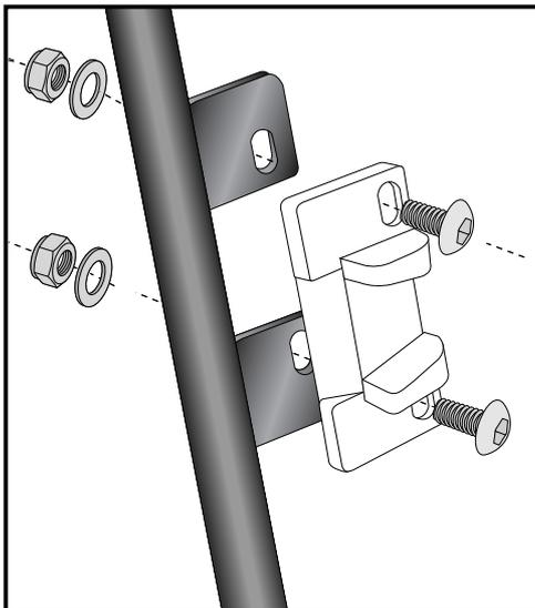
Montage des Metalladapters zum Einhaken des Kofferhalteschlusses
