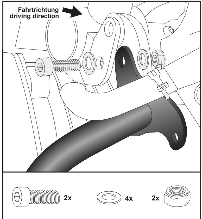
Montage des Motorschutzbügels unten rechts/links:
