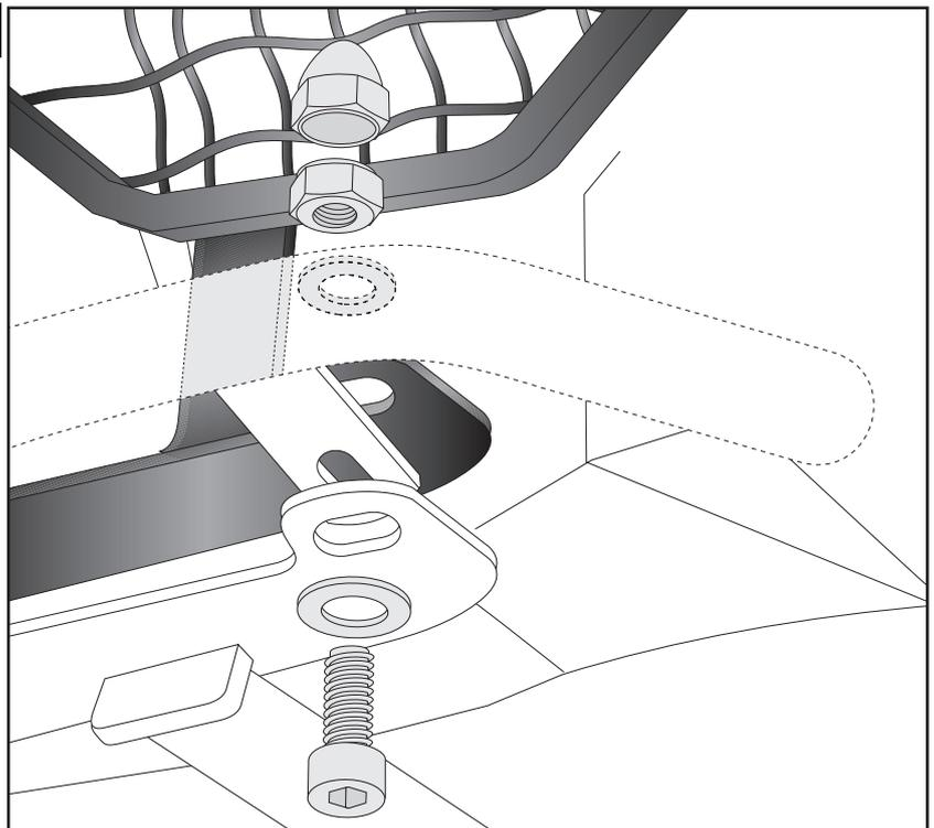
**Montage ohne Tankschutzbügel:**
