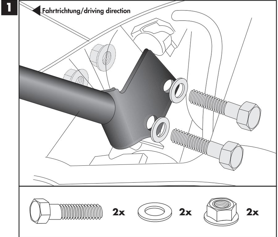
**Montage Tankschutzbügel rechts unten:**
