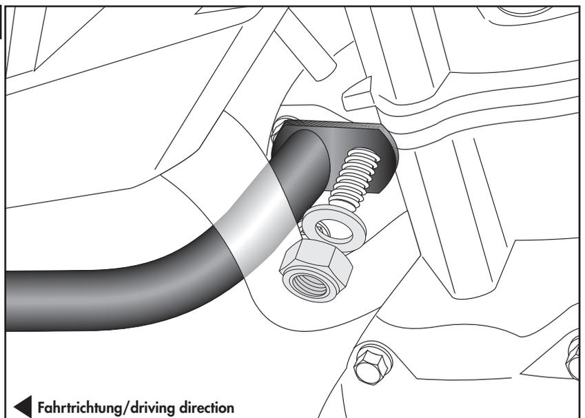
**Montage Tankschutzbügel links oben:**
