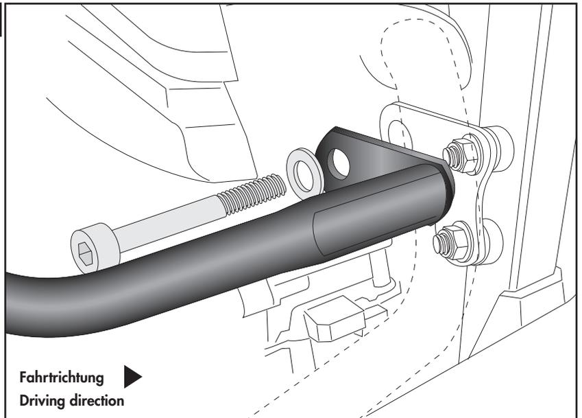
**Montage Tankschutzbügel rechts oben:**
