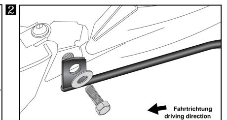
Befestigung hinten links und rechts: Die beiden Originalschrauben des Heckkotflügels ausdrehen (entfallen) Den hinteren Halteadapter an den nun freien Bohrungen mit den Inbusschrauben M6x30 montieren.
