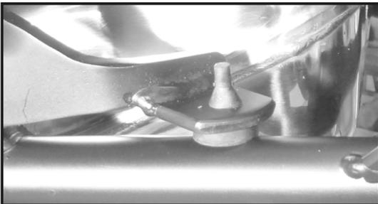
Um an die freien Verschraubungspunkte zu kommen, vorab die Fußrasteranlage links und rechts lösen.
