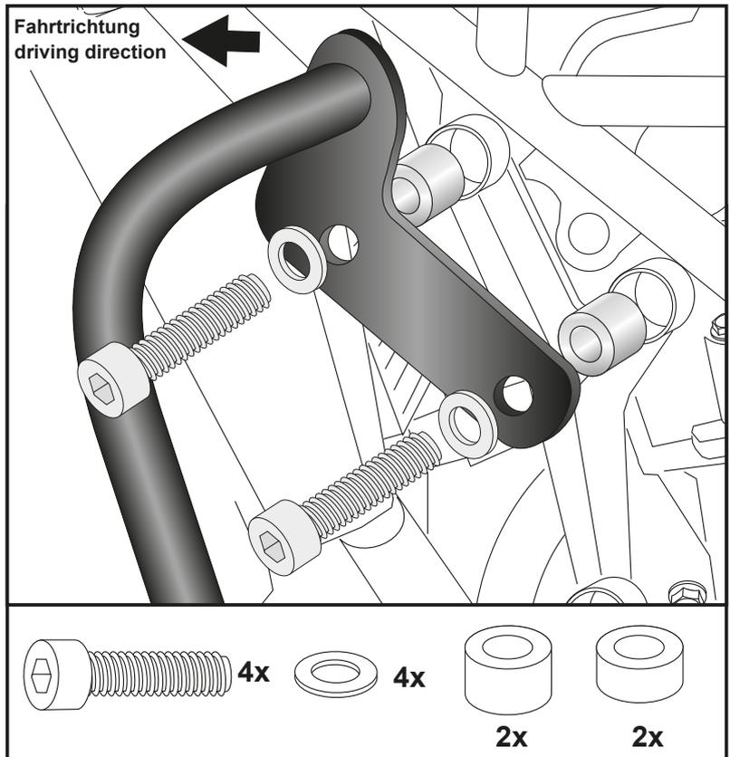
Montage des Motorschutzbügels vorne:
