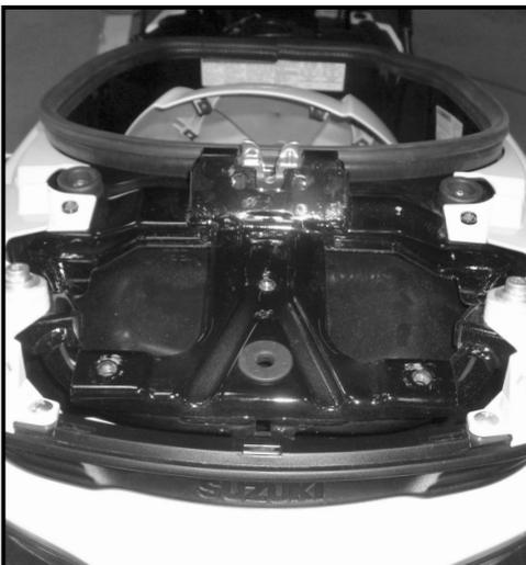
Sitzbank öffnen. Die Original Rückenlehne muß demontiert werden. Zuerst das Polster abnehmen. Dann unten die Schrauben des Kunststoffteils lösen, oben die Clipse vorsichtig lösen. Kunststoffteil abnehmen. Hinteres Kunststoffteil nach Lösen der Schrauben ebenfalls abnehmen. Den nun freiliegenden Stahlrohrhalter demontieren. Nach Demontage aller genannten Teile sollte es so aussehen, wie im nebenstehenden Bild zu sehen.
