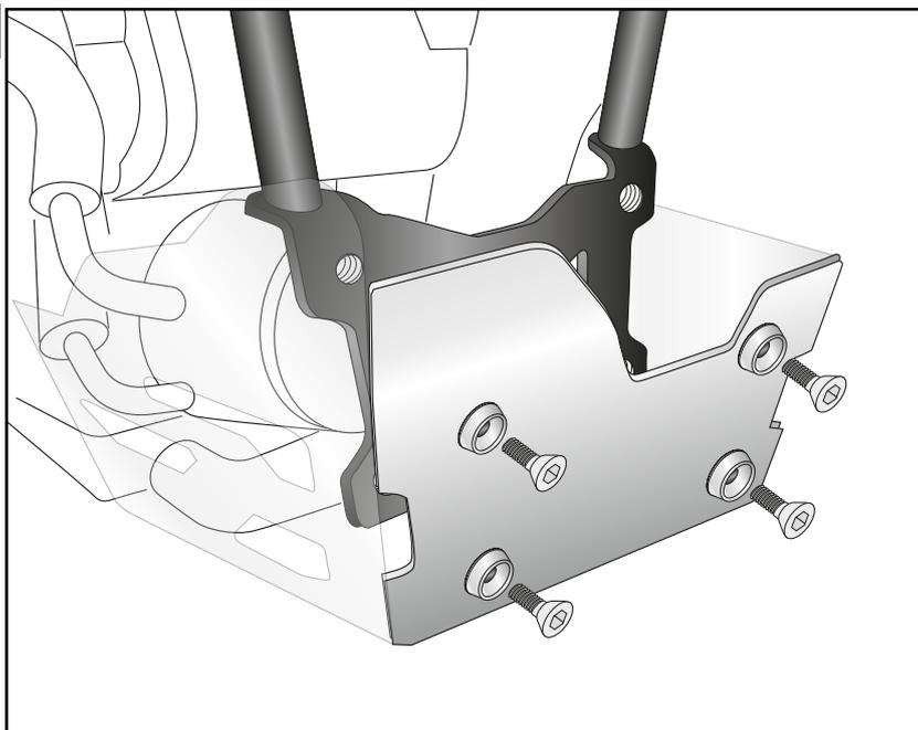
**Montage Motorschutzplatte hinten rechts:**
