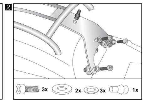
Befestigung hinten oben: zusammen mit dem Haltebügel mit Linsenkopfschraube M6x20 sowie U-Scheibe Ø6,4. Von unten mit U-Scheibe Ø6,4 und selbstsichernder Mutter M6 sichern.
