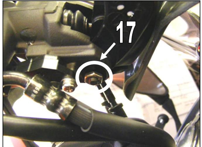
2. Demontieren Sie die Schrauben des Kupplungshebel-Adapters und demontieren Sie den Adapter vom Lenker, wie unten abgebildet. den originalen Gummistopfen (siehe Bild links). Montieren Sie dann die Distanz (15) und den Halter (2) auf diesem Adapter und fixieren Sie den Halter mittels der M10x15 Inbusschraube (16).
