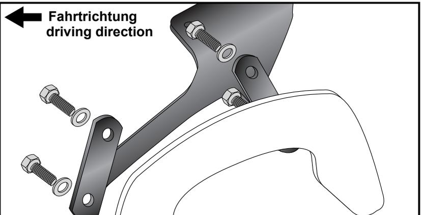
Die so vorbereiteten C-Bow incl. Halteadapter über den Verschraubungspunkten der Haltegriffe positionieren und zusammen mit den Haltegriffen wieder am Rahmenheck verschrauben. Hierzu die Zylinderschrauben M8x80 verwenden. Als Abstandshalter jeweils eine Aludistanz  $\varnothing 18 \times \varnothing 9 \times 22$  mm einfügen.
