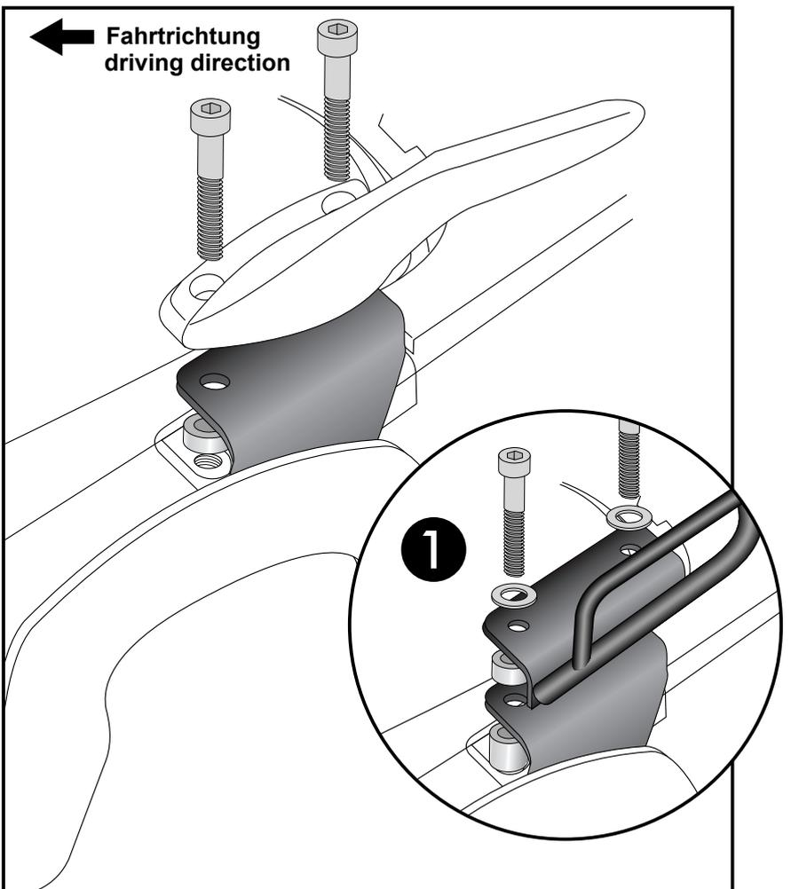
Bei zusätzlicher Montage einer Gepäckbrücke werden die Alu-Distanzen  $\varnothing 18 \times \varnothing 9 \times 15$  mm zwischen Brücke und C-Bow positioniert und mit den Zylinderschrauben M8x80 sowie U-Scheiben  $\varnothing 8,4$  mm verschraubt!
