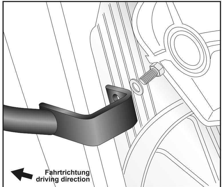
Montage des Motorschutzbügels
