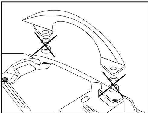
Sitzbank und seitliche Verkleidungsteile (lackiert) demontieren. Haltegriffe demontieren.
