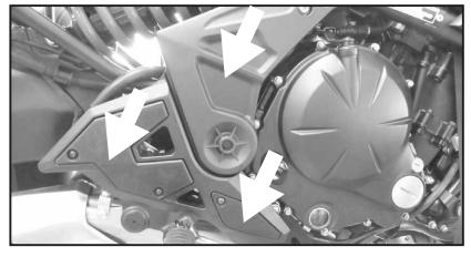
Die drei markierten Originalschrauben entfernen, sowie die Originaldistanzen. Schrauben und Distanzen entfallen.
