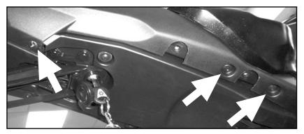
Auf der Rückseite der Verkleidungsteile die vorgeprägte Kontur mit einem Cuttermesser aussparen. Verkleidung wieder montieren. Cut out the pre-stamped contour on the back of the fairing parts with a cutter knife. Refit the fairing.
