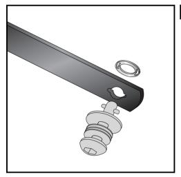
Montage der Lock it System-Schrauben:
