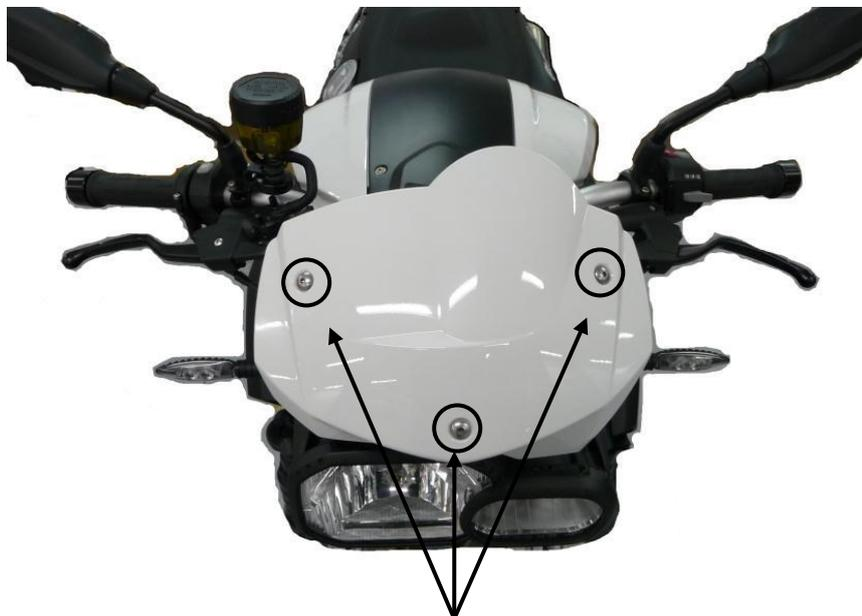
1. Entfernen Sie die 3 Schrauben der originalen Abdeckung.
